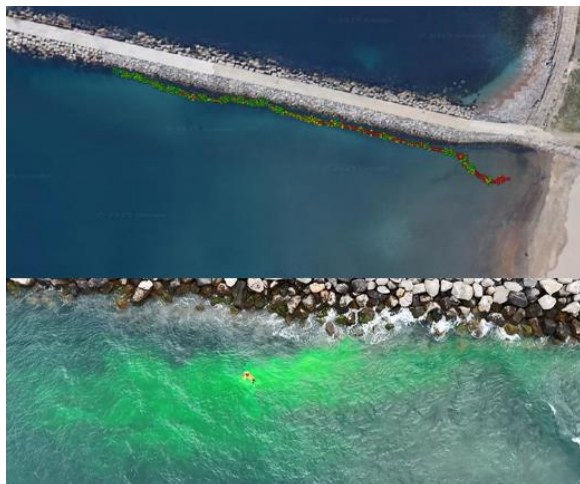
Figura 4. Ejemplo de toma de datos en la playa de Salinas-El Espartal (zona este de la playa, por la parte interior del espigón) empleando el drifter equipado con un equipo GNSS-RTK, la tinta con base de uranina y el maniquí. Fuente: elaboración propia.
