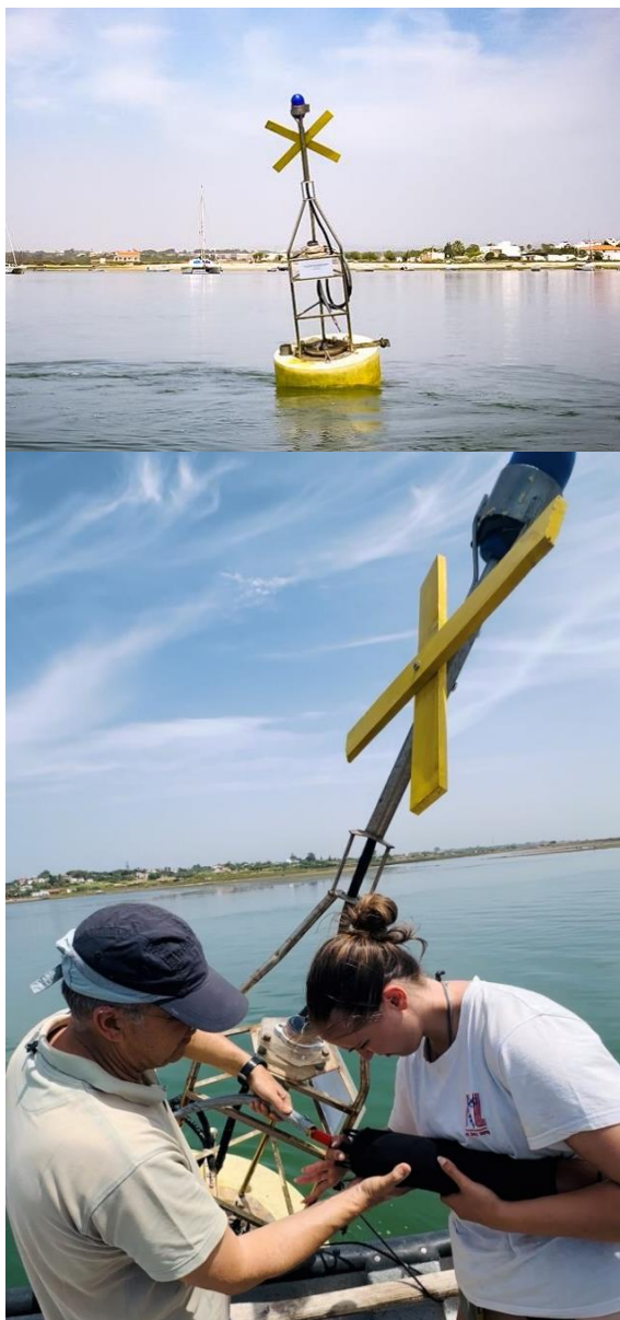
Figura 2. Sonda multiparamétrica NKE, modelo WIMO, instalada na boia oceanográfica de superfície, no Canal de Marim, junto à Praia dos Cavacos, na Ria Formosa.
